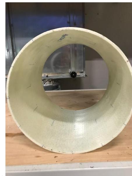
**Le fait qu'un prélèvement soit impossible ne dédouane pas l'applicateur de vérifier mécaniquement la qualité de son chantier → Prélèvement à l'intérieur de la canalisation par ex.**
