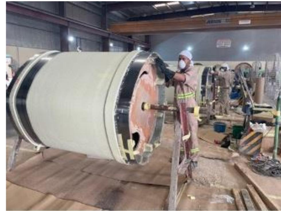
Les éléments composites **PRV CHANNELINE** en Polyester Renforcé de fibres de Verre sont fabriqués par enroulement, imprégnation et projection de couches de matériaux composites sur des moules correspondants au gabarit de l'ouvrage à réhabiliter.
